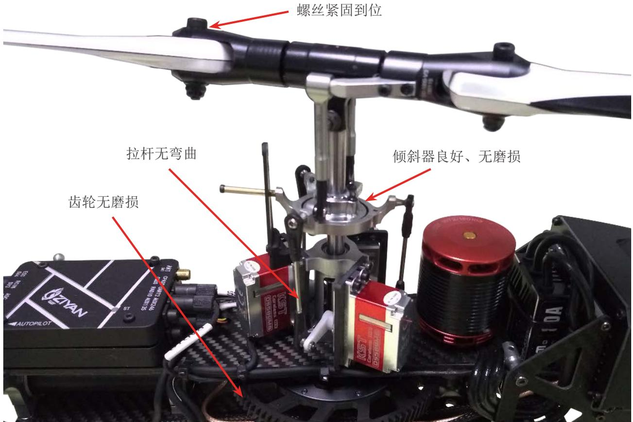
( 检查旋翼系统桨叶连接处倾斜器是否良好、无磨损，旋翼系统拉杆是否无弯曲 )
